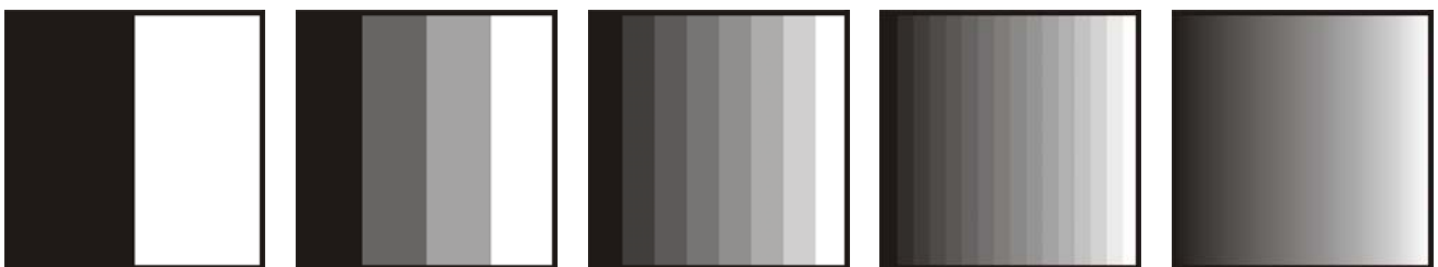
Slika 2. Prikaz plohe s postupnim prijelazom od crne do bijele boje s različitim brojem bita (s lijeva na desno: 1 bit, 2 bita, 3 bita, 4 bita i 8 bita)
